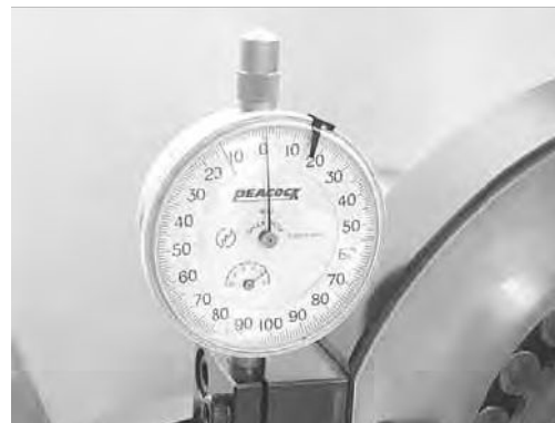
Рис. 1.15 Измерение ширины дистанционного кольца
