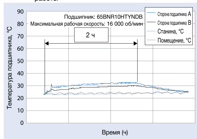
Рис. 3.3 Изменение температуры при прерывистом режиме работы
