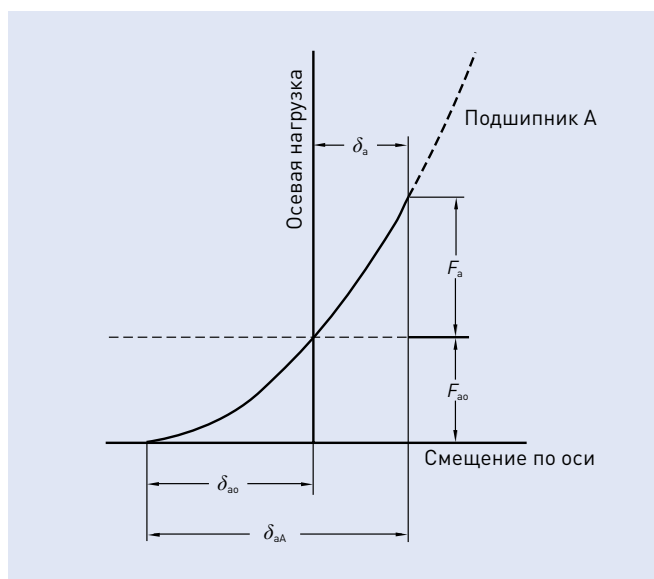
Рис. 4.8 Сравнение жесткости и преднатяга
