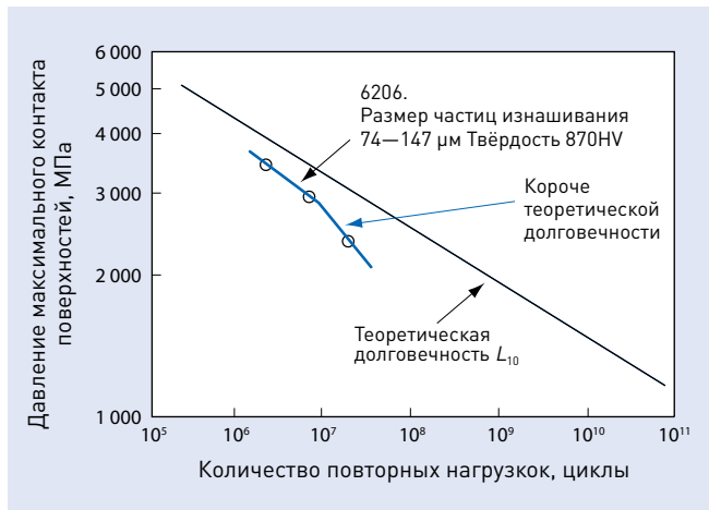
Рис. 1.3 Результаты испытаний на долговечность при использовании загрязненной смазки
