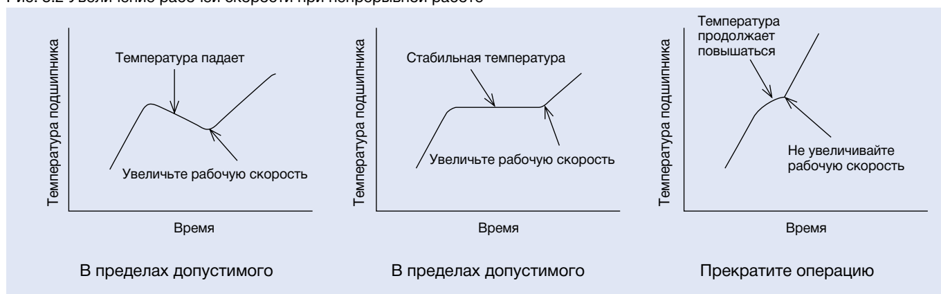
Рис. 3.2 Увеличение рабочей скорости при непрерывной работе
