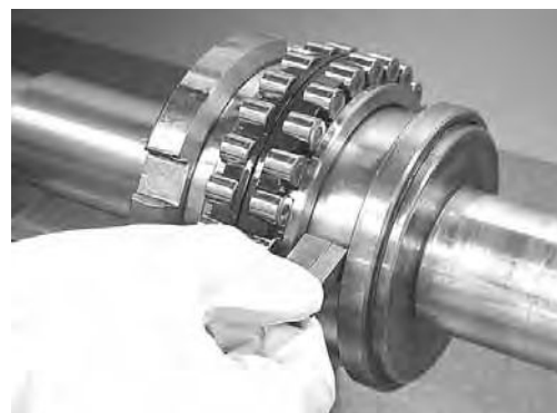
Рис. 1.15 Измерение ширины дистанционного кольца
