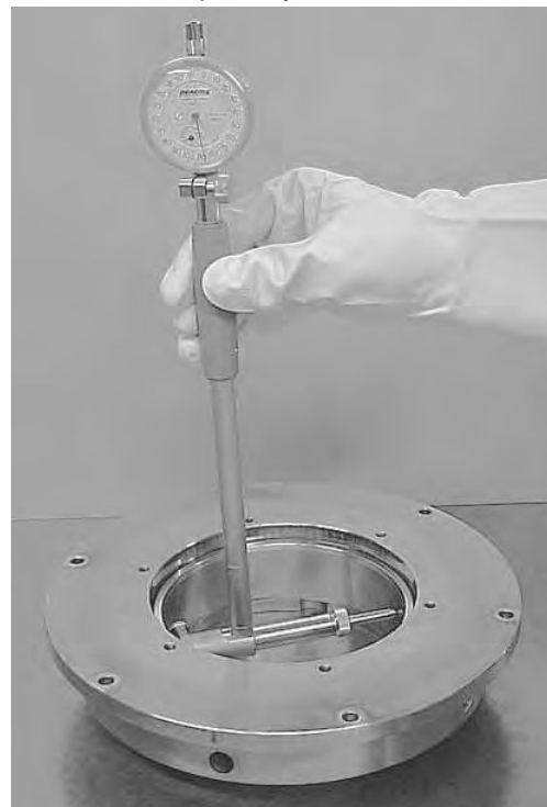
Рис. 1.11 Регулировка вписанного диаметра калибра GN
