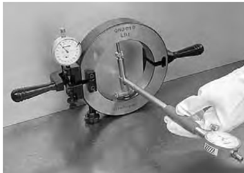
Рис. 1.11 Регулировка вписанного диаметра калибра GN
