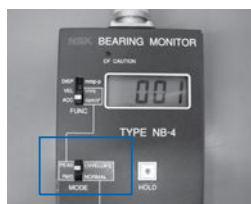
Записывание вибраций, вызванных царапиной внутри подшипника (ENVELOPE)
