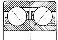
**GB** Однорядные радиально-упорные шарикоподшипники в универсальном исполнении, т. е. пригодные для установки парами по любой схеме: 0-образной, X-образной или tandem. При установке по 0-образной или X-образной схемам возникает больший предварительный натяг, чем при GA.
