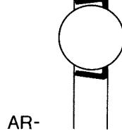
Примеры: 4 F-UC1306TM Радиальный роликоподшипник с цилиндрическими роликами.
