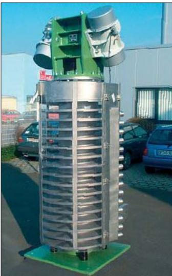
Рис. 21 Спиральный транспортер с прозрачным пылезащитным кожухом и подключениями воздуха охлаждения
