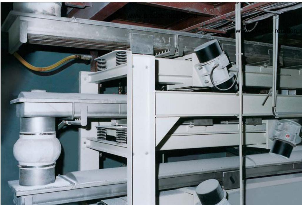
Рис. 6. Три охлаждающих желоба, расположенные каскадом
