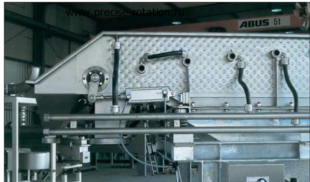
Рис. 17 Просеивающая машина с обогреваемыми
