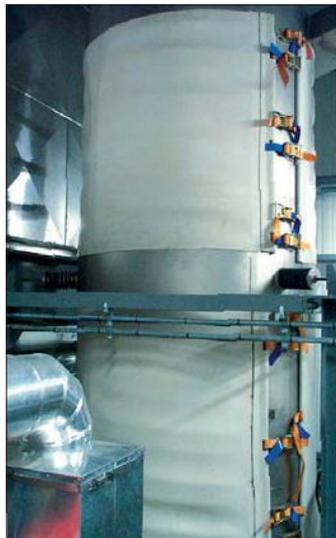
Рис. 22 Спиральный транспортер с пылезащитным кожухом из натурального каучука
