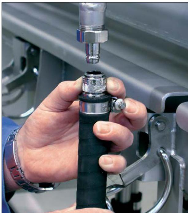
Рис. 3 и 4 Виброжелоб с водяным охлаждением с быстроразъемным подсоединением охлаждающей магистрали
