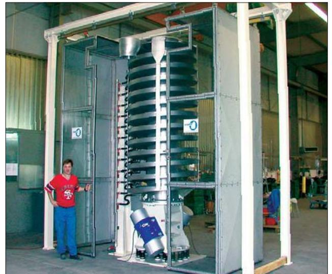
Рис. 23 Спиральный транспортер с прозрачным пылезащитным и звукопроницаемым корпусом. Корпус состоит из 2 подвижных половин, висящих на направляющих. Для чистки эти половини раздвигаются.
