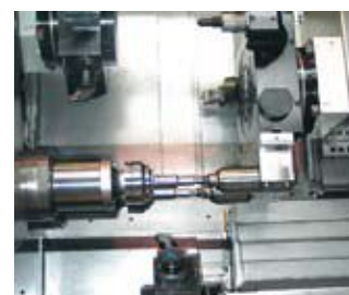
NDM 200-6T Рабочая зона двух шпинделей
