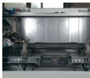
NZM 450-4/300 с револьверной головкой, имеющей корончатую форму, для обработки железнодорожных осей весом брутто 700 кг и размером диаметра 240 мм x 1960 мм
