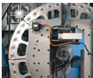
Магазин с 40 инструментами и отверстием для подачи материала через загрузчик прутков
