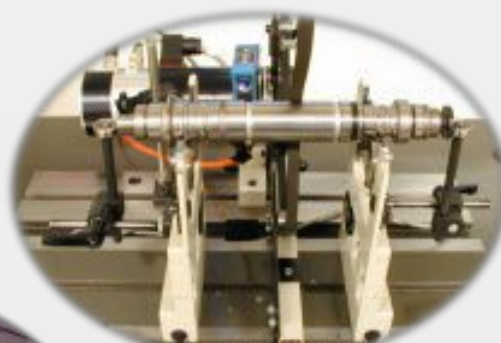
Точная балансировка шпиндельного вала
