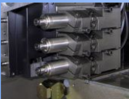
Шпиндели HF25 на токарном станке "швейцарского типа"
