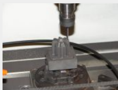
Фрезерование графитовых электродов на HF80
