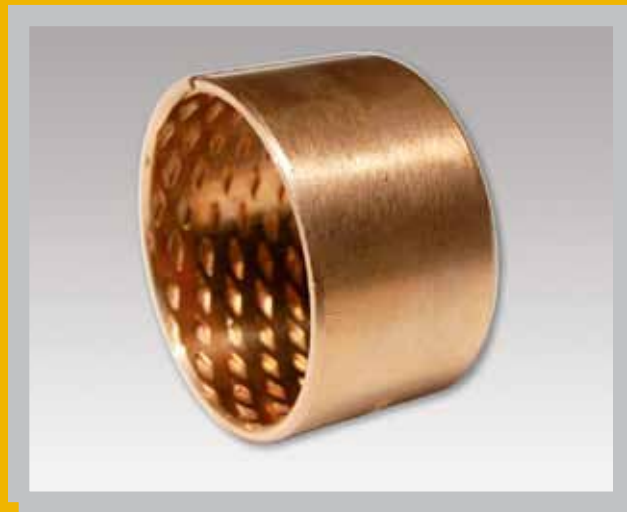
GEROLLTES BRONZEGLEITLAGER, SCHMIERTASCHEN, WARTUNGSARM
