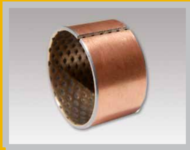
GEROLLTES VERBUNDGLEITLAGER, STAHL/BRONZE, GEFÜLLTE SCHMIERMITTELDEPOTS, WARTUNGSFREI
