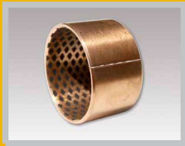
GEROLLTES BRONZEGLEITLAGER, GEFÜLLTE SCHMIERMITTELDEPOTS, WARTUNGSFREI
