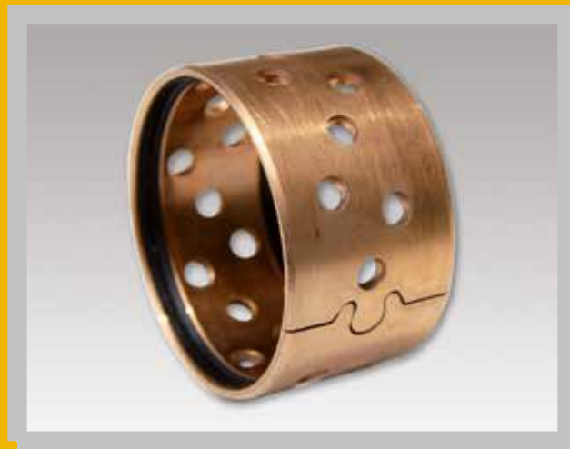
GEROLLTES BRONZEGLEITLAGER, LOCHDEPOTS, DICHTUNG, WARTUNGSARM
