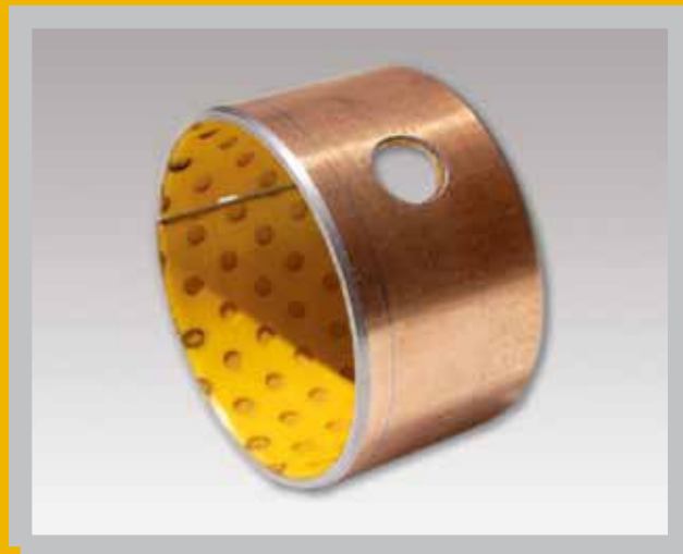
GEROLLTES VERBUNDGLEITLAGER, STAHL / ACETALHARZ (POM), SCHMIERTASCHEN, WARTUNGSARM
