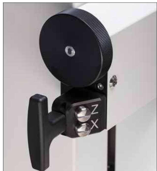
Einhandbedienung mit selektiver Achsbedienung One hand operation of both X and Z axis
