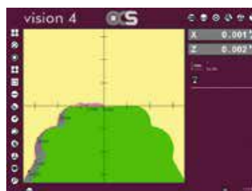
DXF-Overlay für SOLL-IST Vergleich (optional) DXF-files for nominal/ actual comparisons (optional)
