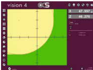
Radiusmessung über 3-10 Messpunkte Radius measuring with up to 10 points
