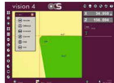
R/D und Absolut-/Kettenmaß Auswahlmenü Radius/ dia and abs/ inc selectable
