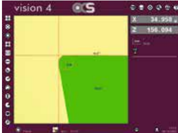
Schneidenerkennung und Vermessung mit virtuellem Fadenkreuz Automatic cutting edge detection with virtual crosshair
