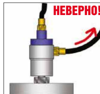
Отводной шланг направлен вверх
