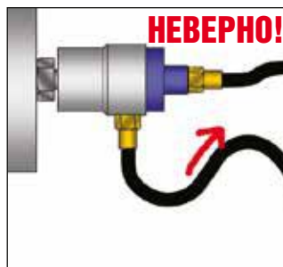
Участок шланга направлен вверх
