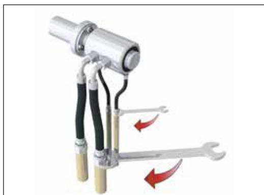
Рис. 4: Шланги проведены под углом в 90°
