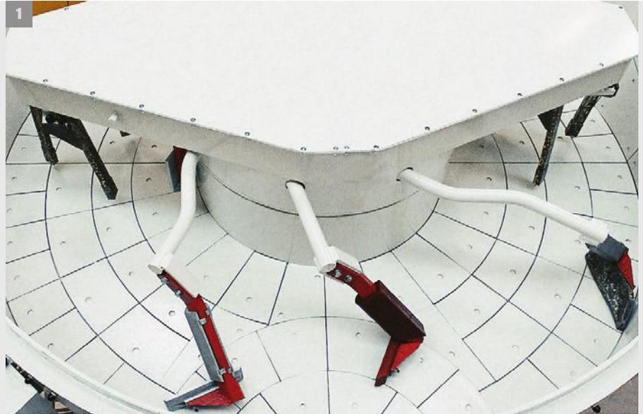
Der Wirblerantrieb erfolgt über den Hauptantrieb des Mixers. Für besondere Einsätze kann die Wirblerdrehzahl durch den Wechsel der Riemenscheibe verändert werden. Mit einem Frequenzumrichter lässt sich die Getriebedrehzahl und damit die Wirblerdrehzahl, zum Beispiel für den Befüll- und Entleervorgang, variieren.
