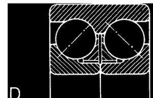
2. Внутренняя деталь (внутреннее кольцо с двумя комплектами роликов) или наружная деталь (наружное кольцо с двумя дорожками качения) двухрядного конического роликоподшипника типа «K-»
